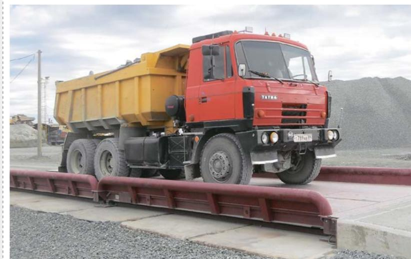
**Модель ВА-О – стационарные автомобильные весы повышенной прочности, надёжности и безопасности.**
