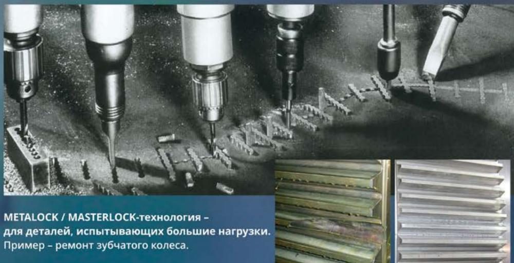
METALOCK / MASTERLOCK-технология – для деталей, испытывающих большие нагрузки. Пример – ремонт зубчатого колеса.
