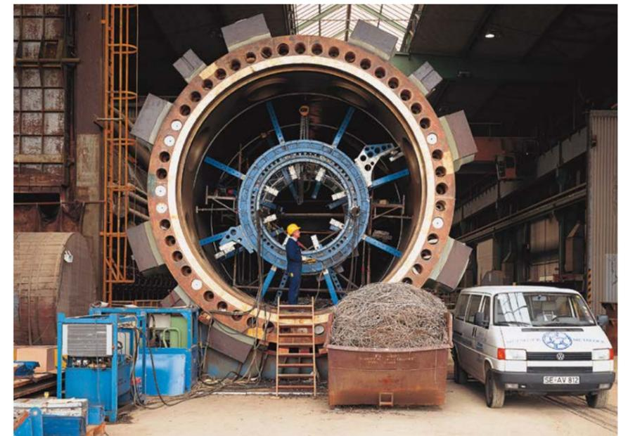
Разрезание атомного реактора Ø 6500 мм на три части для транспортировки
