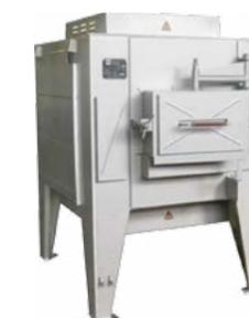
Предназначена для нагрева деталей под закалку, для термообработки высоколегированных и быстрорежущих сталей, отжига стальной проволоки и ленты, керамики.
