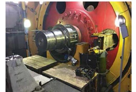
Проточка и шлифовка вала Ø 850 мм без демонтажа
