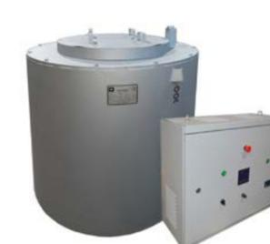
Применяются для переплава и перегрева алюминия и его сплавов на производствах в качестве раздаточных печей, поддерживающих температуру расплавленного металла перед разливкой в формы.
