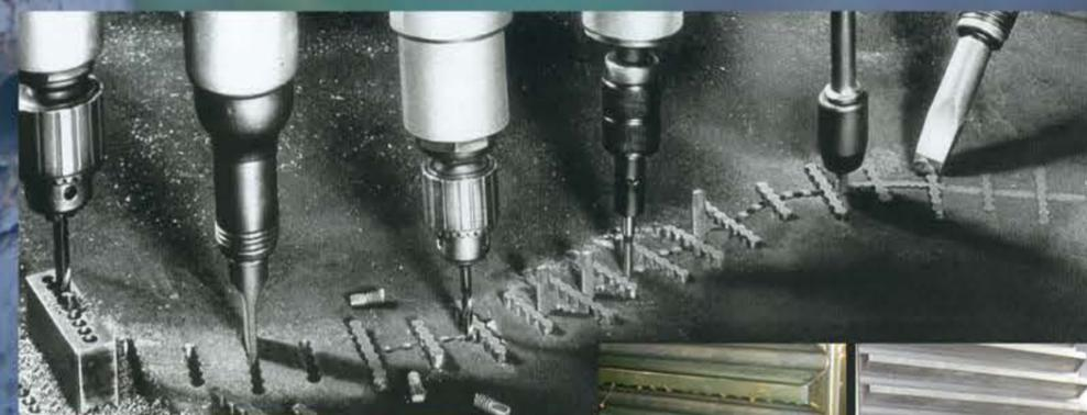
METALOCK / MASTERLOCK-технология – для деталей, испытывающих большие нагрузки. Пример – ремонт зубчатого колеса.
